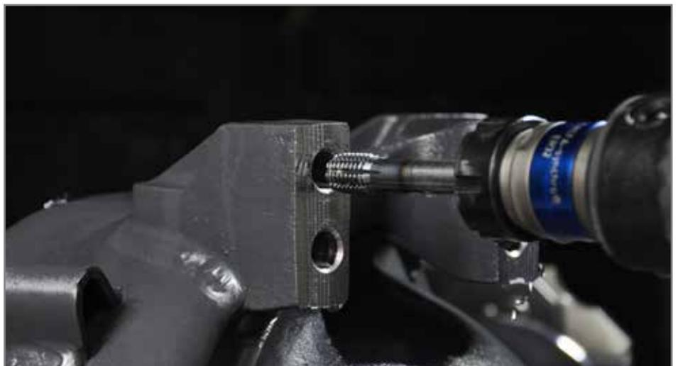
OSG高效XPF挤压丝锥在加工过程中不会产生切屑的问题，并同时适用于加工硬度高达35HRC的材料。
